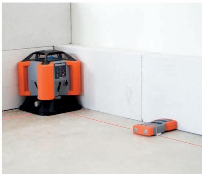
**Sofisticado.** En el desarrollo del LINUS<sup>1</sup> HV se han adoptado numerosas ideas innovadoras. Las dimensiones de la carcasa del láser y del receptor láser ACCEPTOR<sup>Line</sup> están perfectamente adaptadas entre sí. La distancia entre el plano láser vertical y el canto de la carcasa del LINUS<sup>1</sup> HV y la distancia desde el canto de la carcasa hacia la línea cero del receptor láser son idénticas.
